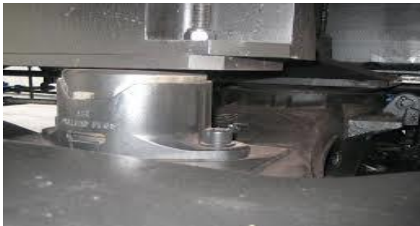
Рисунок 4. Скользун MV-18 SB фирмы «Miner Enterprises, Inc».
